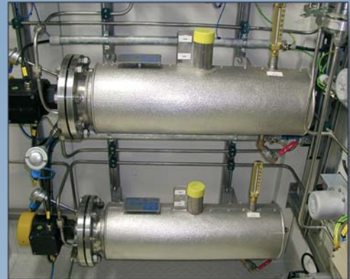
Cl / HCl-Verdampfer 20 bzw.10 kg/h; 10 kW
