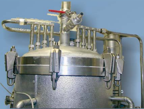
HCl-Verdampfer 160 kg/h; WST:Hastelloy
