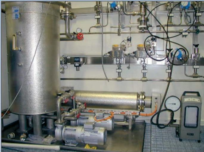
Verdampfungsanlage für HCl
