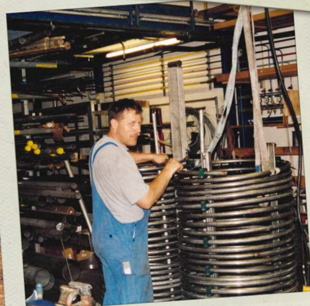
Andreas Wolf beim Bau eines Wärmetauschers Anfang der 90iger Jahre
